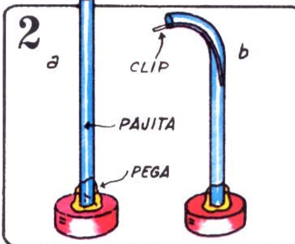
Coloca un extremo de la pajita en el agujero. Ponle pegamento (a). Endereza un clip. Dóblalo por un extremo e introducelo en la pajita (b).
