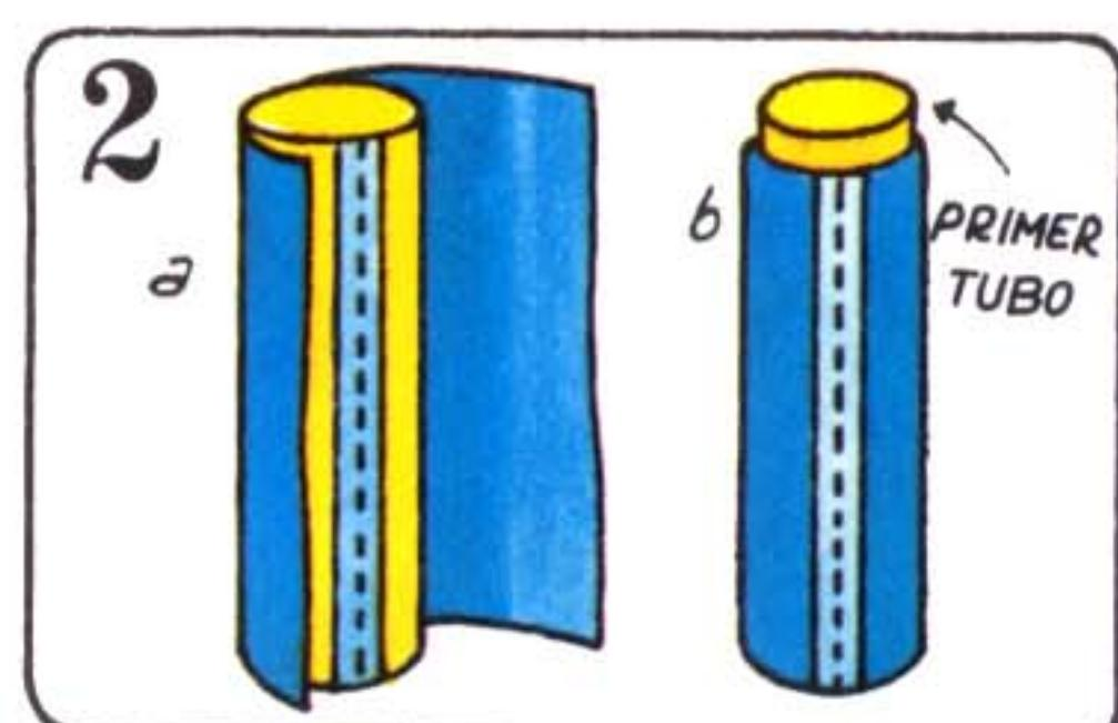
Coloca el tubo metálico sobre una hoja de cartón o de papel (a). Envuelve el tubo holgadamente para formar otro tubo. Pega los bordes con cinta adhesiva (b).
